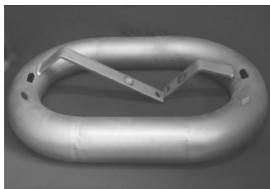
图2 断裂均压环及支腿全貌
